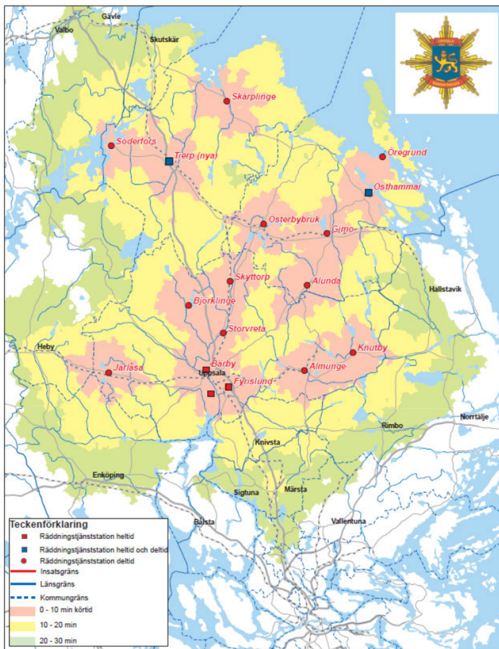
Figur 10. Insattider i Uppsala brandförsvars geografiska område med dagens organisation. Figuren visar tiden till dess att första enhet är framme på plats och skadeavhjälpande åtgärder påbörjas. För RiB-stationerna avser detta FiP-enheter. I kartan är utgångspunkten för alla enheter respektive brandstation. För RiB-stationerna är zonerna ungefärliga då inte FiP-enheterna normalt sett utgår från brandstationen utan från den plats personen som bemannar enheten har beredskap för stunden befinner sig.
