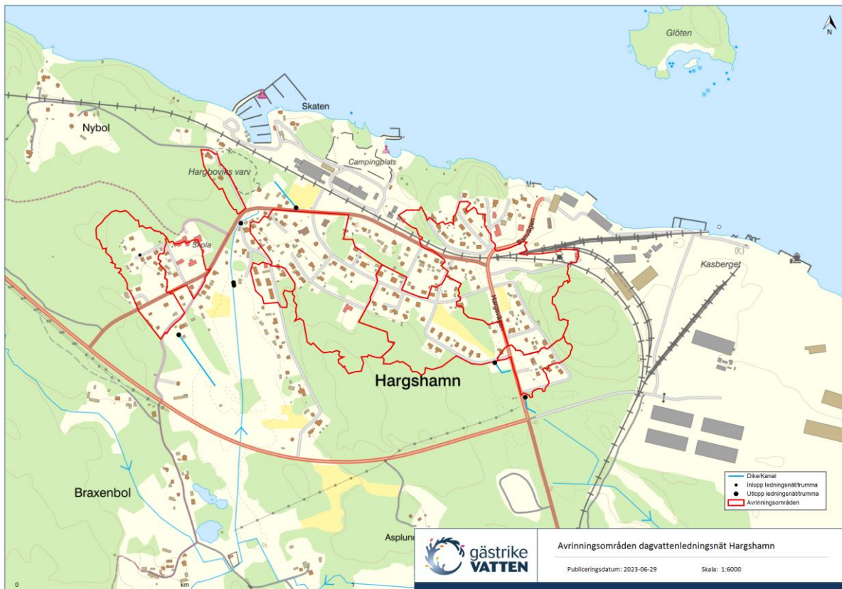
Figur 5.4. Avrinningsområde för dagvattenledningsnätet i Hargshamn.
