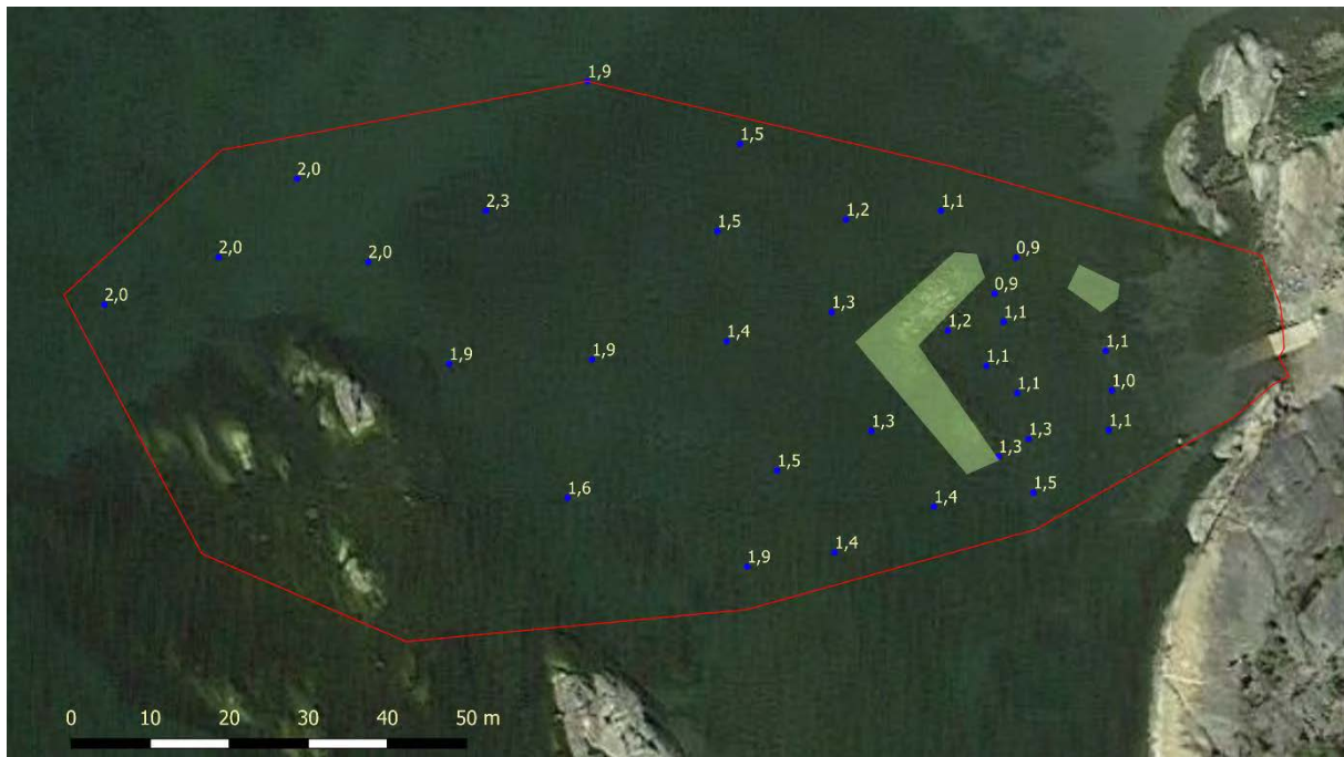
Figur 2. Det inventerade vattenområdet inramat med rött. De blå punkterna anger djupmätningar med djupet i meter. De grönskuggade ytorna visar läget för de stenkistor som anlades för kol- och vedutskjeppning från Gräsö till Forsmarks bruk. Vattendjupet här är endast runt halvmeter.
