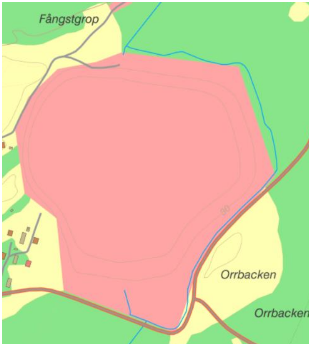
Figur 7: Karta som visar markens genomsläpplighet med ungefärligt planområde markerat i rött. Röd färg visar på hög genomsläpplighet, gul färg medelhög genomsläpplighet och grön färg visar låg genomsläpplighet.
